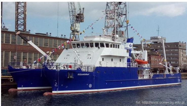
Pierwszy w świecie polski elektryczny napęd statku morskiego o łącznej mocy 1,4 MW.
